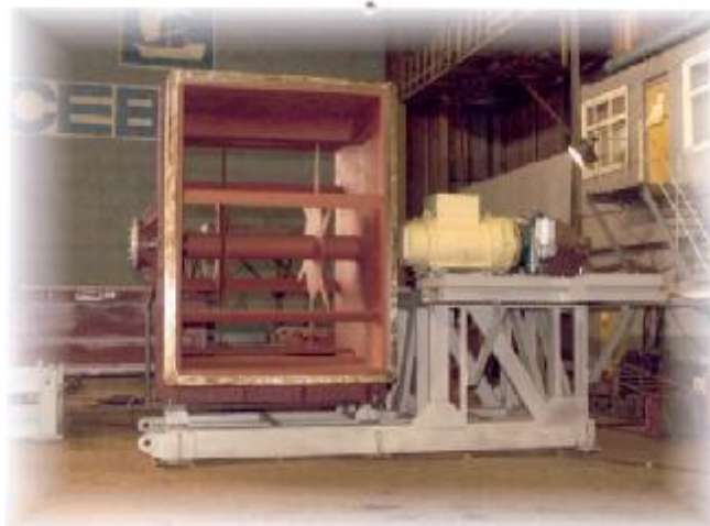
Рис. 3. Ортогональный гидроагрегат с рабочим колесом диаметром 2,5 м для Кислогубской ПЭС
